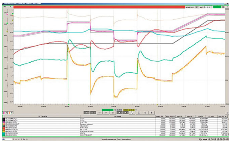
Рис. 9. Испытания НПРЧ блока ст. № 3 (скользящее давление пара, низкая нагрузка) Пермской ГРЭС
