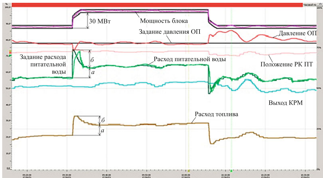
Рис. 5. Испытания ОПРЧ блока ст. № 5 Рефтинской ГРЭС
